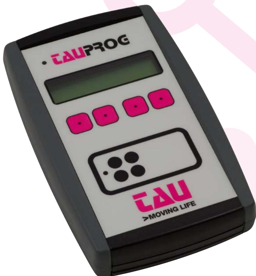
Un pratico palmare per la programmazione, duplicazione e controllo dei sistemi a radiocomando *rolling code* TAU.
